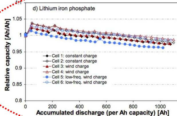
Gli accumulatori Litio ferro fosfato (LiFePo<sub>4</sub>) mostrano nei test sia la vita utile più lunga che il comportamento più stabile e prevedibile durante invecchiamento. Questo sia rispetto a Litio – ossidi di Cobalto che rispetto a Litio cobalto Manganese
